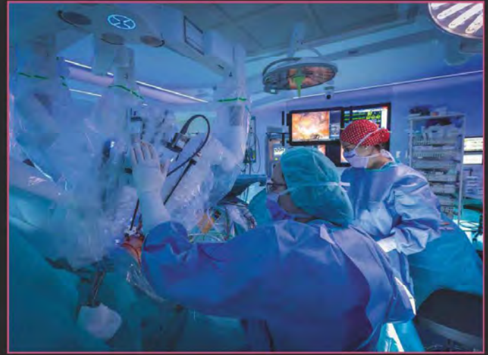
09:33 h Uno de los brazos del robot controla un endoscopio tridimensional con dos cámaras; aquí lo colocan en el cuerpo del paciente.
